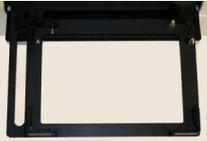
，放入微孔板，其中 A1 位对准微孔板托架的左上角。按 **START**
